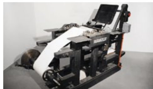
Première machine BOBST : presse pour le gaufrage du Braille
