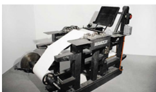
Première machine BOBST : presse pour le gaufrage du Braille.
